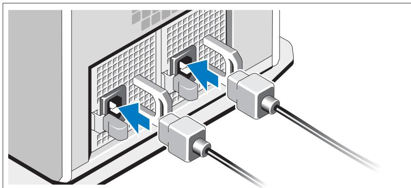
连接系统电源电缆至系统，并且，如果使用显示器，连接显示器电源电缆至显示器。
