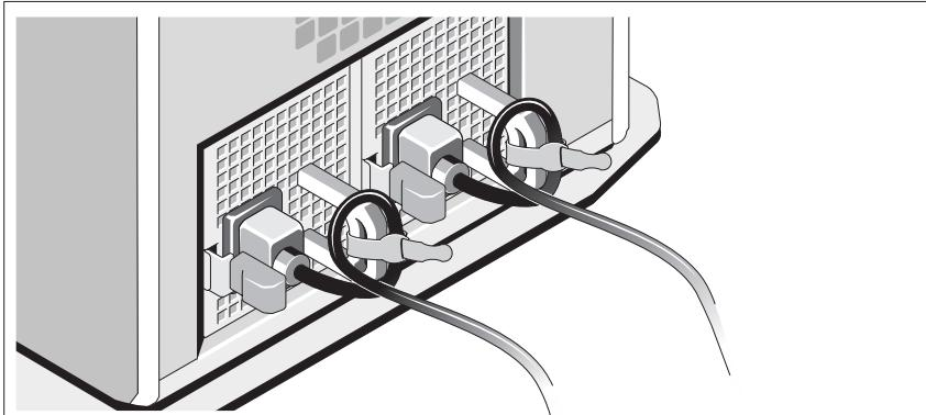
Tekuk kabel daya sistem secara melingkar seperti ditunjukkan pada gambar kemudian kencangkan kabel ke braket dengan pengikat yang tersedia.
